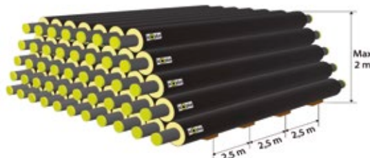
Billede 4.1.2 Rør på strøer der ikke er understøttet skal sikres med stropper i.h.t billed 4.1.3
