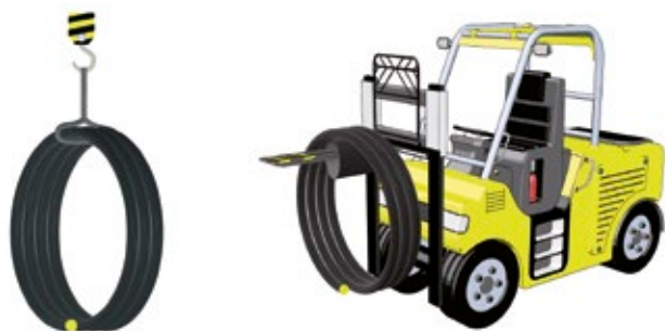
Billede 3.3.3 Aflæsning af flexrør med truck
