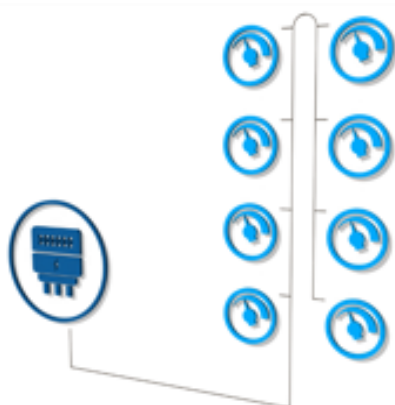
Figur 4: Akseptert kabling-struktur: Bus
